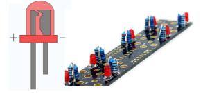
NOTE! With a +. IF YOU ARE USING A PANEL WITH HOLES FOR THE LEDS THEN DO NOT SOLDER THEM FLUSH TO THE PCB LIKE THIS! YOU MAY WANT TO SOLDER THE JACKS AT THE SAME TIME TO GET THE RIGHT 14. HEIGHT
